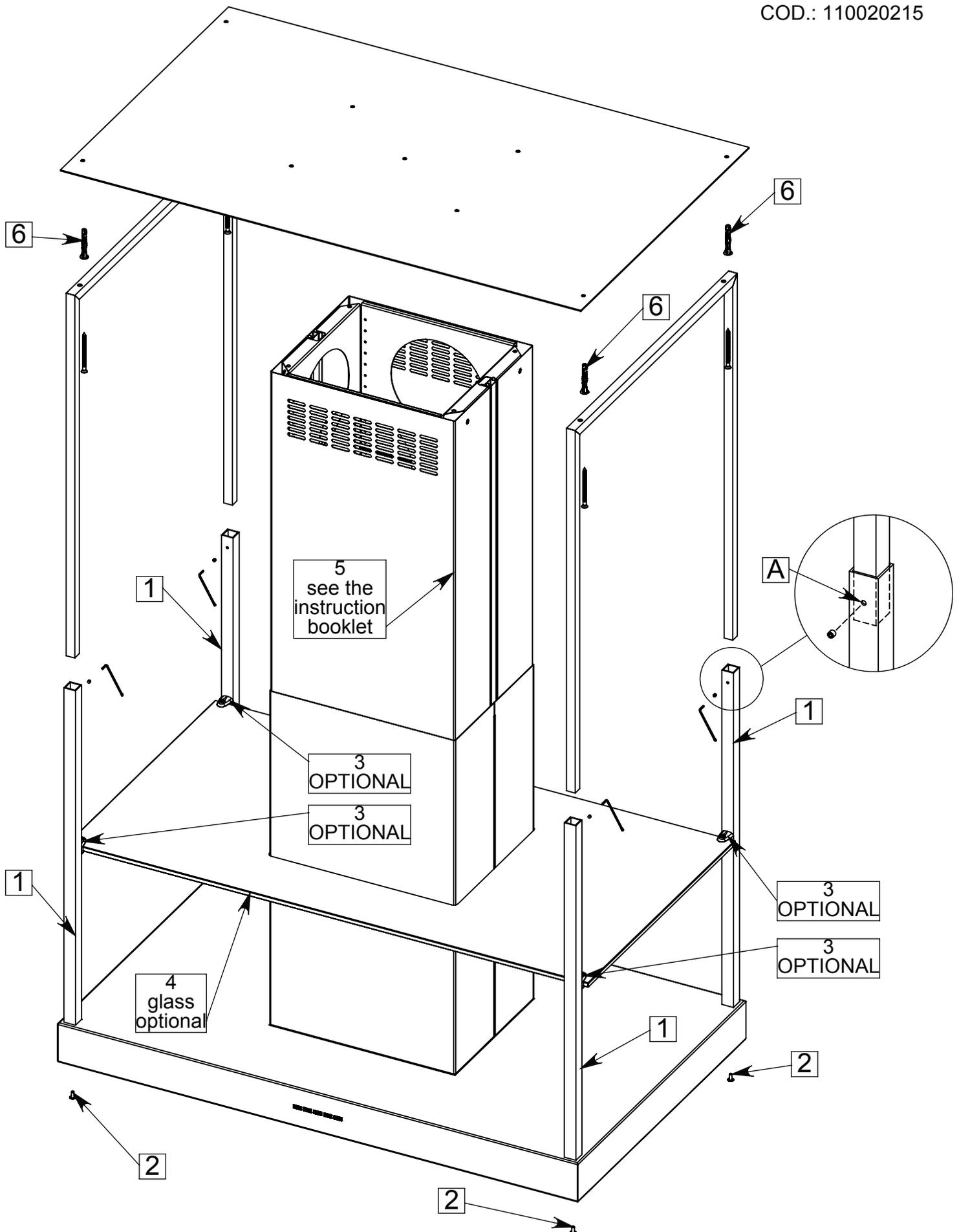
Per migliorare la tenuta del grano definire la posizione dei fori "A". Forare il traliccio superiore in corrispondenza della posizione "A" con punta  $\varnothing 2,5$  mm. Ripetere l'operazione per ciascun traliccio superiore.
